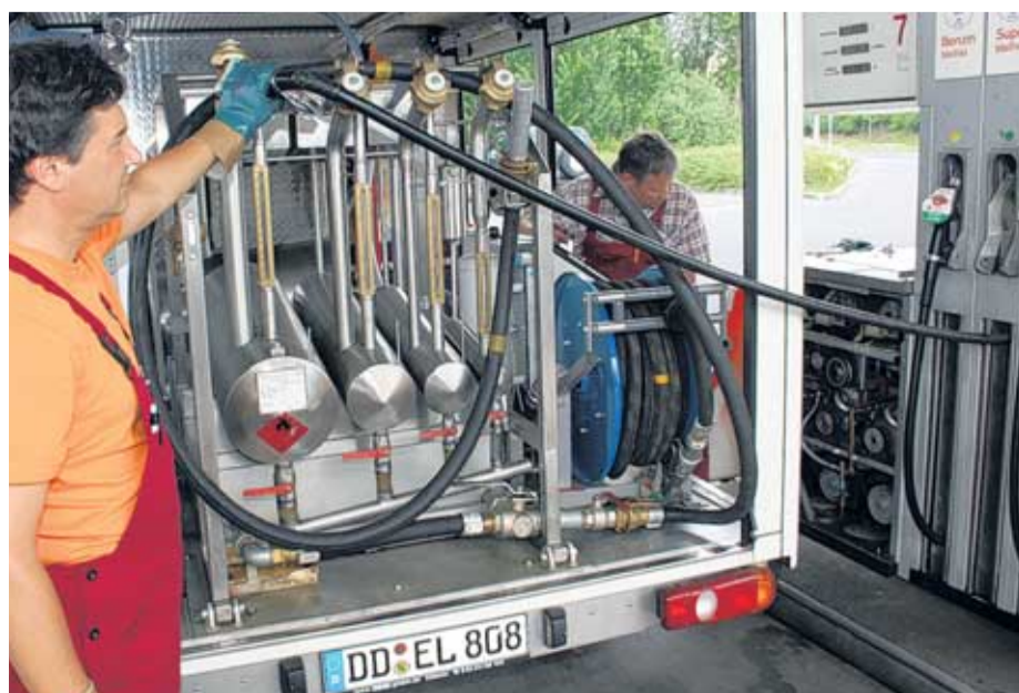
Die Eichmeister Matthias Otto (vorn) und Ronald Straube eichen die Zapfsäulen an einer Tankstelle, indem sie verschiedene Messbehälter ihres Spezialfahrzeuges befüllen.
