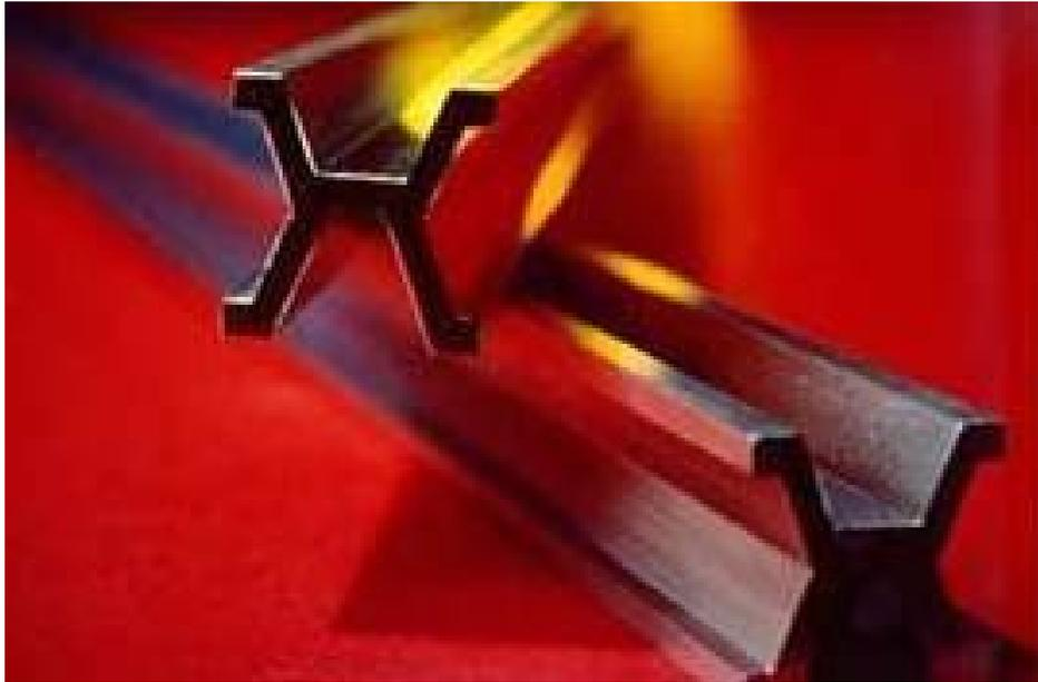
Meterprototyp aus einer Legierung aus 90% Platin und 10% Iridium
